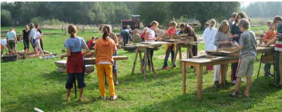
Schülerprojekt zur Fliesenherstellung im traditionellen Handstrichverfahren. Foto: Verein Technisches Denkmal Ziegelei Benzin, 2006
