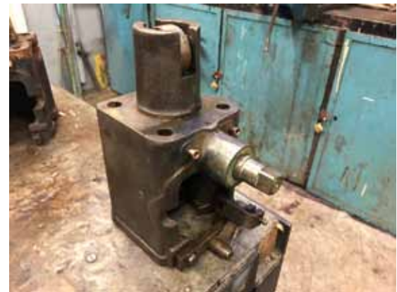
Die gleiche Einspritzpumpe nach der mechanischen Reinigung. Foto: Schiffahrtsmuseum Rostock
