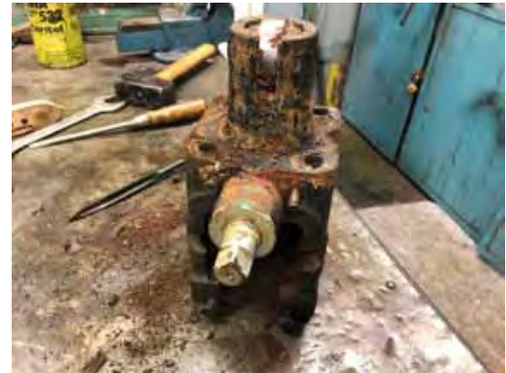
Verrostete Einspritzpumpe für Zylinder. Foto: Schiffahrtsmuseum Rostock
