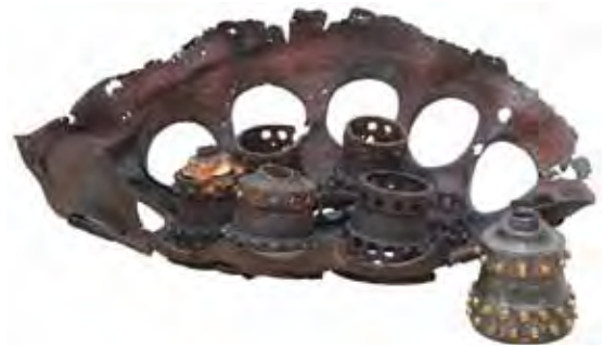
Deformierter Rest des Tellerbodens und der Einspritzdüsen des Brennkammerkopfes einer 1944 abgeschossenen A 4-Rakete, Propagandabezeichnung „V 2“. Foto: PLM
